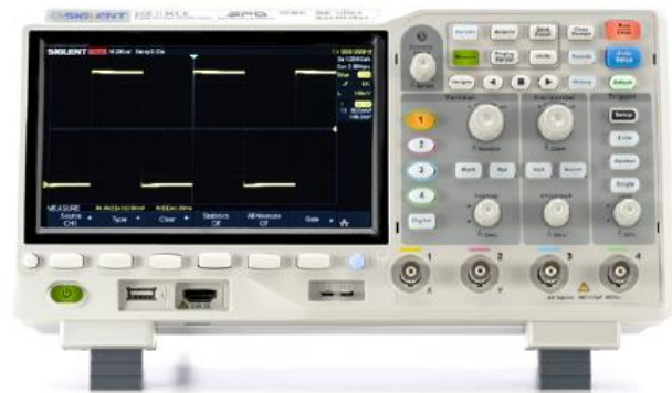
Fot. 14.5. Płyta czołowa generatora sygnałowego dla porównania z płytą miernika uniwersalnego Fot. 14.7. Model SDS1104X-E. Gniazda LAN i USB u dołu po lewej stronie są używane do ładowania programów, zdalnego sterowania, aktualizacji oprogramowania wewnętrznego i zapisu danych z ekranu
