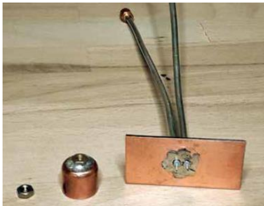
Fot. 8.13. Płytkę z laminatu przed przylutowaniem rezonatora
