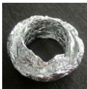
Rys. 8.8. Zgnieciona folia aluminiowa do elektrycznego uszczelnienia styku rurki z otworem w LNB
