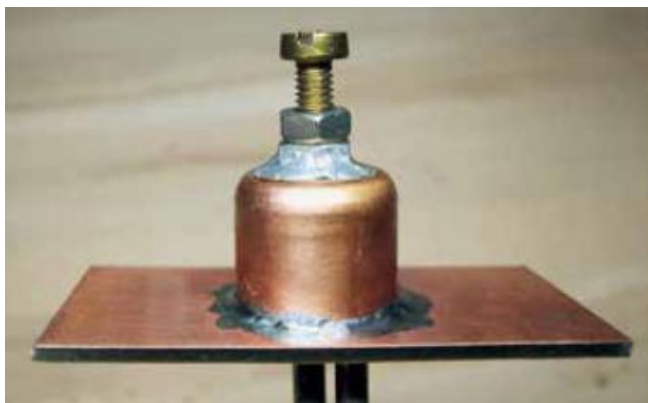
Fot. 8.13. Płytkę z laminatu przed przylutowaniem rezonatora
