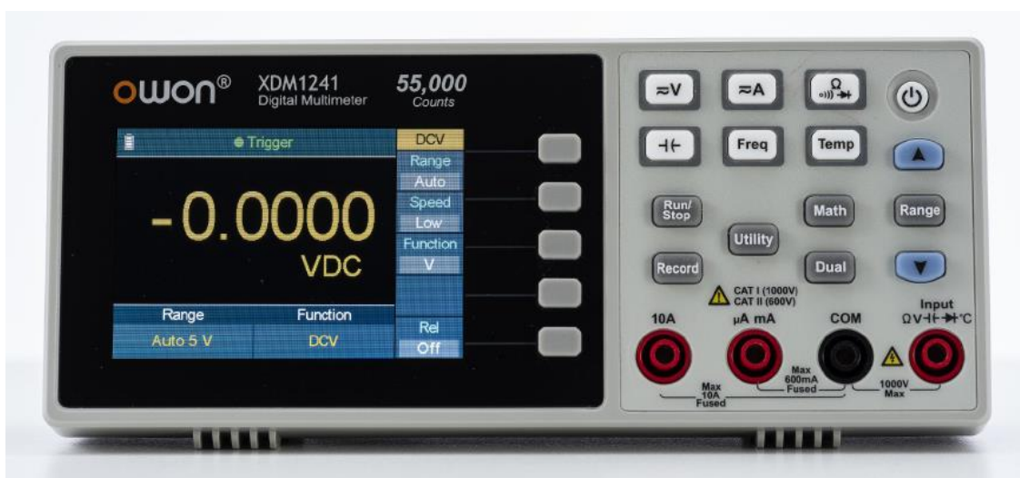
Fot. 14.3. Płyta czołowa cyfrowego miernika uniwersalnego. Po lewej stronie widoczny jest wyświetlacz ciekłokrystaliczny, po środku przyciski programowalne, po prawej stronie przełączniki mechaniczne
