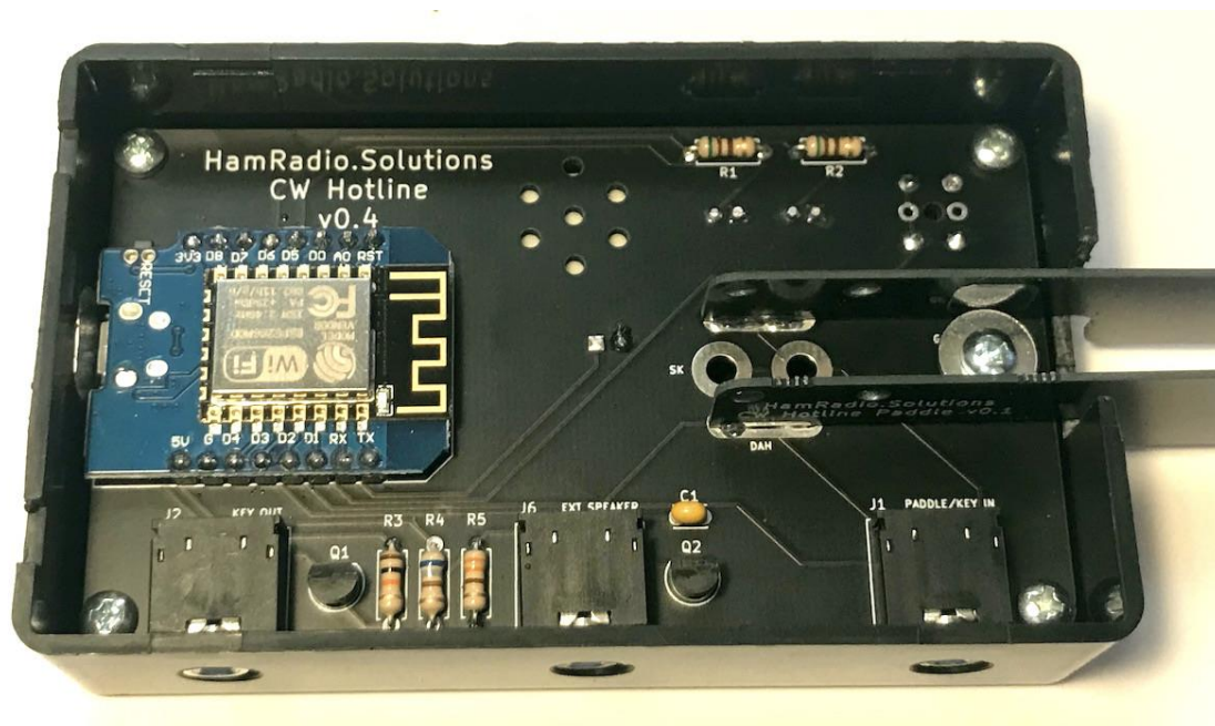
Fot. 5.2. Konstrukcja z wmontowanym kluczem bocznym. Ramiona klucza są widoczne po prawej stronie płytki, a moduł mikrokomputera po lewej
