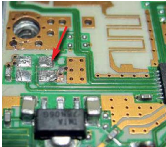
Fot. 8.9. Wnętrze przykładowego LNB Fot. 8.10. Kontakty na płytce po wylutowaniu oscylatora
