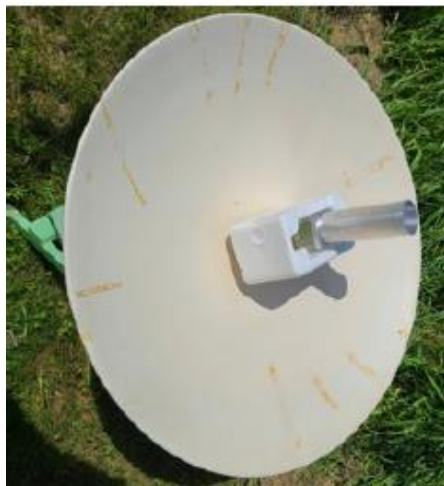
Fot. 12.1. Pomiar współczynnika szumów własnych przy użyciu anteny rożkowej o wąskim kącie promieniowania polega na porównaniu szumów słonecznych, szumów nieboskłonu i powierzchni ziemi. Reflektor eliminuje niepożądane szumy pochodzenia ziemskiego w trakcie pomiarów szumów słonecznych i pochodzących ze sklepienia niebieskiego
